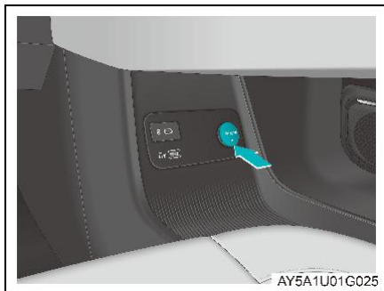
Conector de alimentação de 12V do subpainel do painel de instrumentos
